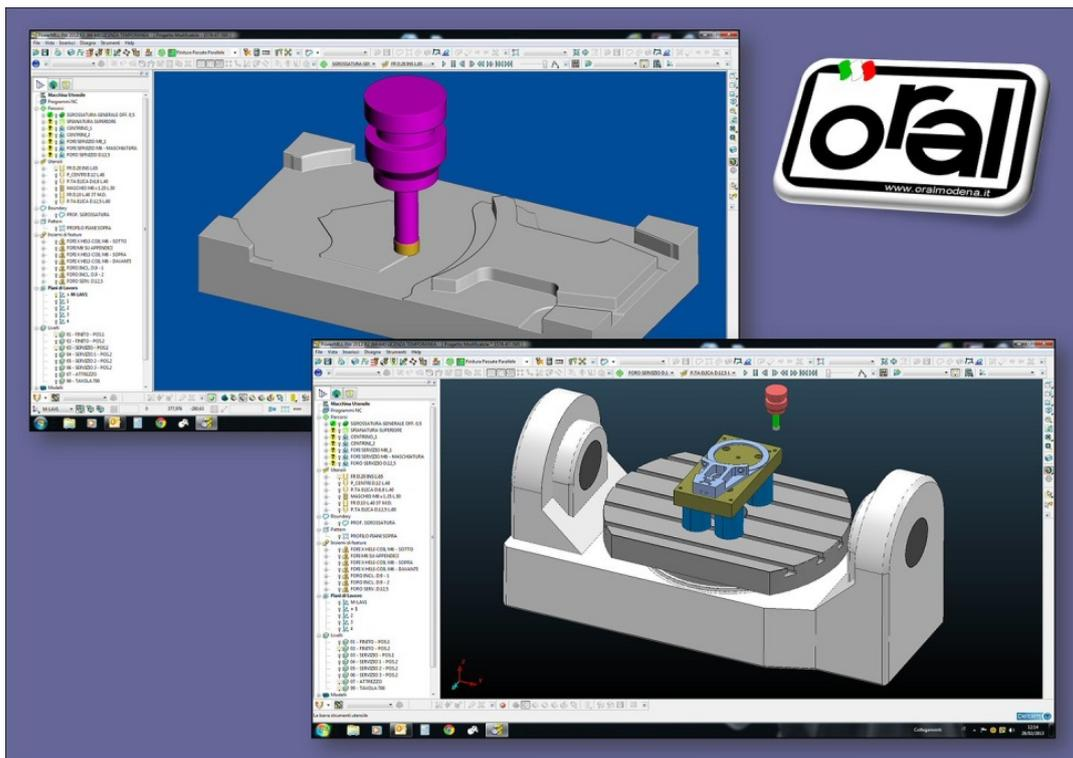
**PowerMILL** è il prodotto di punta di Delcam per la fresatura a 3, 4 e 5 assi, un sistema CAM indipendente che permette la creazione rapida di percorsi NC da modelli CAD. Completato da una potente interfaccia che ci consente di accettare dati da qualsiasi sistema CAD, via IGES, VDA, STL o vari tipi di convertitori diretti.
